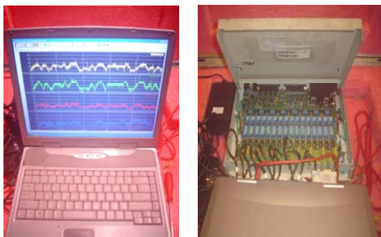
SISTEMA DE AQUISIÇÃO DE DADOS Realização de extensometria/telemetria na estrutura de pontes rolantes em tempo real.
